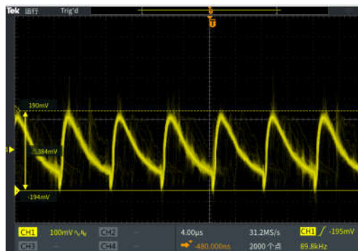
图四不推荐测试方法为 \Delta V_{pp}=384mV
